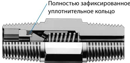
Компактный монолитный корпус
